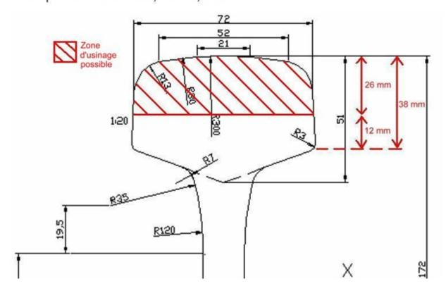
A l'issue de l'usinage, un ressuage permettra d'être rassurer sur l'élimination totale de la fissure. L'opération suivante consiste à mettre en œuvre un moule de soudure aluminothermique adapté au profil du champignon autour de la zone curetée (voir photo n°3). La suite des opérations ressemble à la méthodologie d'une soudure aluminothermique.
