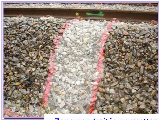
Zone non traitée permettant de mesurer la pénétration de Canasoil en profondeur (ici 50 cm)
